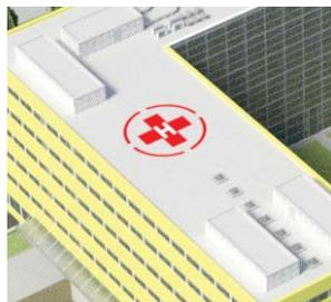
**Um Heliporto** é uma área especial para aterragem de helicópteros numa cobertura. Pelo que estas áreas devem ser à prova de água, resistentes mecanicamente e à abrasão, com propriedades de ponte de fissuras dinâmicas e estáticas. As superfícies também devem ser estáveis à luz UV e não libertar poeiras sob a forte corrente descendente dos helicópteros. Normalmente, essas áreas também devem incluir e exibir marcações visuais (ex: sinalética, logótipos, etc...) com cores vívidas.
